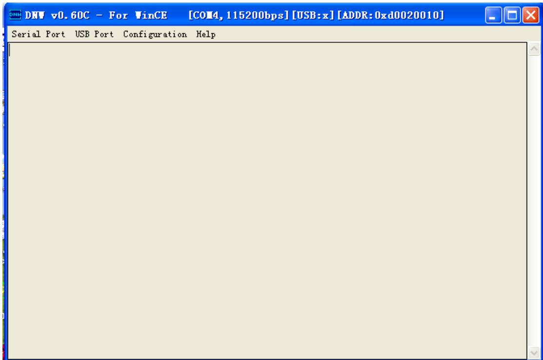
打开开发板电源，按住 POWER 键(SW12)不放，这时，DNW 上的 USB 会显示 OK，再点击 USB Port->Transmit，找到 x210\_usb.bin 文件，双击，这时，DNW 上的 USB 会显示 x 后再显示 OK，表明 210 芯片的寄存器已经初始化完毕。
