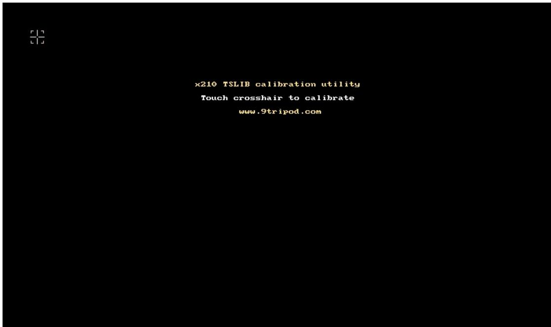
依次点击十字架进行校屏。校正完成后，会在/etc 目录下生成最新的校屏文件 pointercal。这时，电阻触摸屏就能正常操作 UI 界面了。
