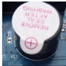
该蜂鸣器为有源蜂鸣器，有直流电时会鸣叫，通过三极管控制电源的导通与截止。硬件电路通过一路 PWM 控制三极管，即可以用于 PWM 测试，也可以用于适当场合的声音提示。
