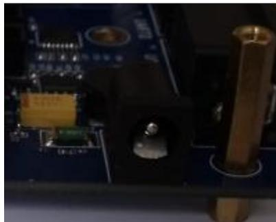
i210 采用 9V 直流电源供电，图中黑色插座为 9V 直流电源输入插座，删除了原来 x210 上的电源总开关。
