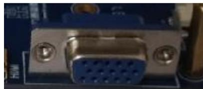
J33 为 VGA 接口，通过编写程序可实现 800\*600,1024\*768,1280\*1024,1440\*900 等分辨率的 VGA 信号输出。
