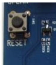
SW11 为硬复位按钮。如果 R54 空焊, 则按下 RESET 键后系统会掉电关机。如果 R54 焊上 0R 电阻, 则按下 RESET 键后系统会复位重启。
