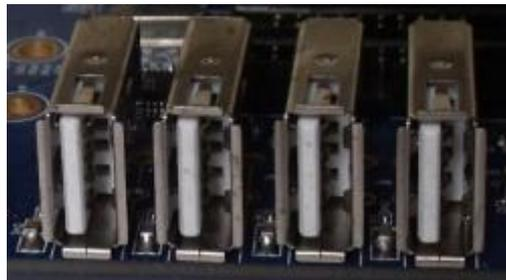
S5PV210 默认只有一路 HOST, 使得我们很难扩展其他功能。i210 开发板使用了 USB 扩展的 HUB 芯片 GL850G, 将一路 HOST 通过硬件的方式扩充到四路, 无需任何软件, 可以无缝支持 USB 鼠标, USB 键盘, USB WIFI, USB 蓝牙, USB 3G 等。
