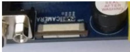
该接口为通用的 24PIN 摄像头接口，直接支持 OV 全系列摄像头，省去 camera 转接板。针对不同型号的摄像头，只需按照摄像头的规格，调整一下输出电压就行了。同时，TVP5150 TVIN 模块也是从该接口引出的。
