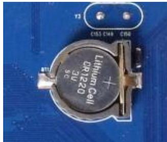
后备电池用于保证断电后 RTC 仍然能够工作, 确保系统时间不丢失。
