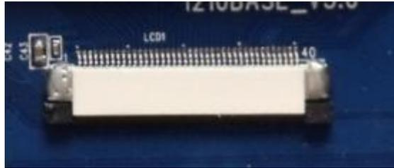
i210 开发板默认留有一个 40PIN 的 LCD 接口,通过软排线将 RGB 相关信号连接到 LCD 控制板上,进而控制 LCD。同时,这个 40PIN 接口的第一个管脚为 PWM 脚,用于控制 LCD 的背光。通过 PWM 实现多级背光亮度调节。VGA 接口, LVDS 接口, TVOUT 接口都通过该接口实现。
