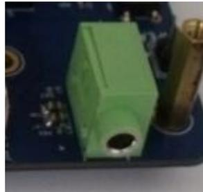
将耳机接入该接口，可以实现耳机输出。当然也可以直接通过该接口送到功放输入，如家庭影院的音频输入接口，实现将开发板的音源信号通过家庭影院展现出来。
