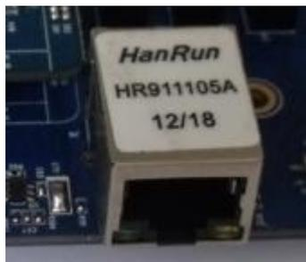
i210 支持有线以太网接口，板载 DM9000CEP，用户可以通过有线以太网上网。
