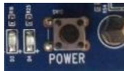
SW12 为开关机按钮。连接好外部适配器电源后, 再长按 SW12 实现开机。进入 android 系统后, 轻触 SW12 实现休眠, 再次按 SW12 实现唤醒。长按 SW12 实现出现关机界面, 按照屏幕提示关机。
