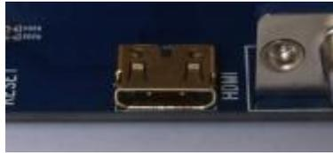
x210,x210ii,i210 开发板均采用 miniHDMI 接口，配合 miniHDMI 的延长线，可以将音视频信号完美的呈现在支持 HDMI1.3 协议的监控终端，如电视机，显示器等。
