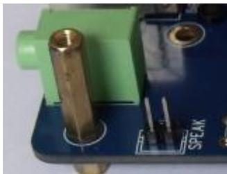
开发板直接支持扬声器输出，将喇叭接到上图接口，可实扬声器输出。
