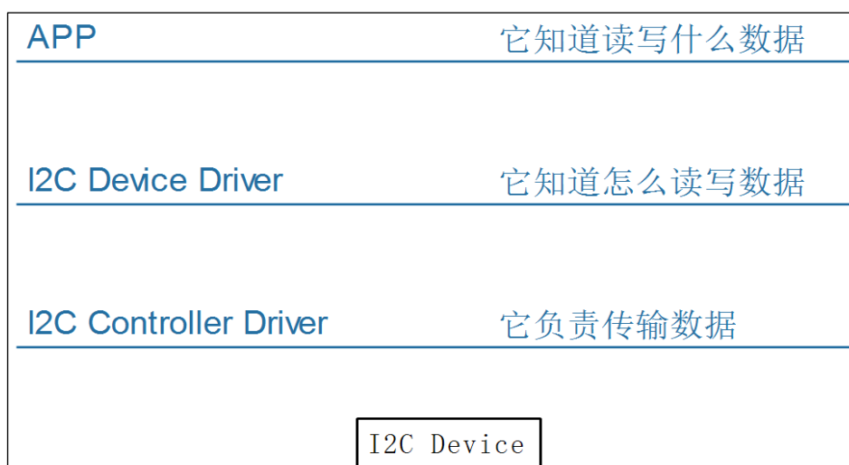
图 10.2 I2C 软件框架
