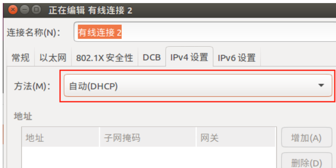
图 1.4.3-4 设置 NAT 网络适配器为自动获取 IP 模式
