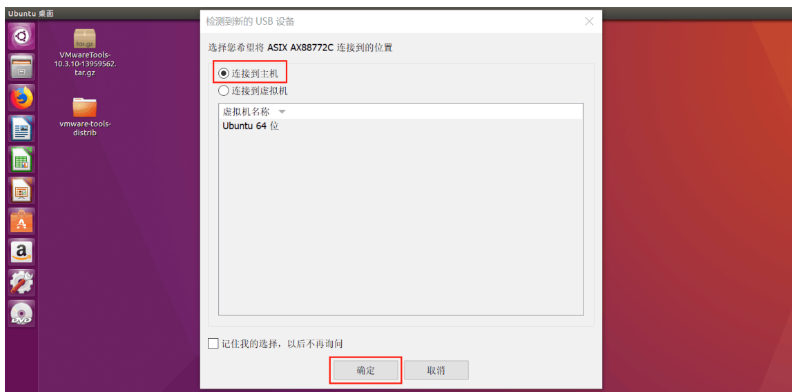
图 1.5.2-12 将 USB 转网口设备连接到 Windows 主机
