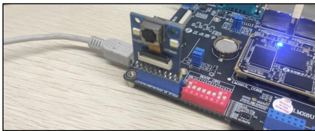
图 3.16.1 2 ov5640 与 ALPHA 开发板接法
