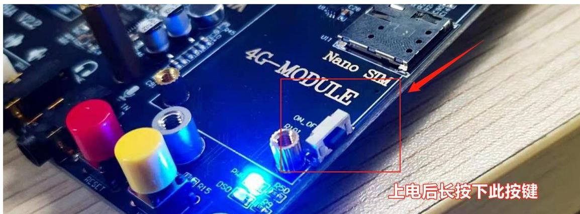
图 1.3.10-3 开发板软关机后上电
