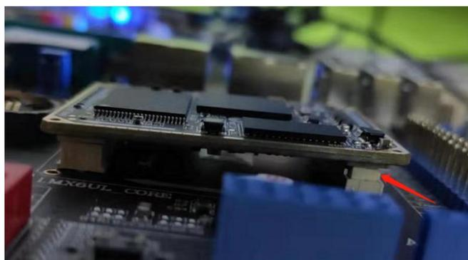
图 1.3.12-2 安装错误示例
