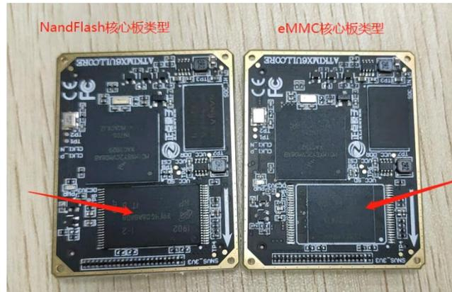
图 1.2.2-1 NandFlash 核心板和 EMMC 核心板
