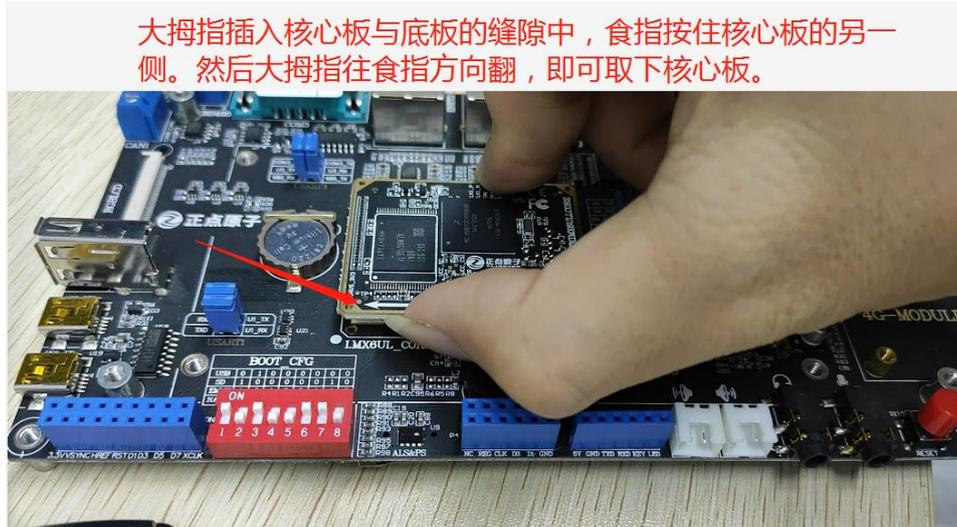
图 1.3.11-1 取下核心板
