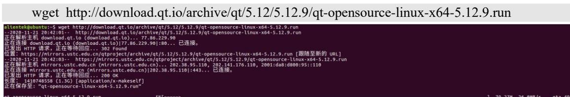
图 5.1 2 使用 wget 指令在 Ubuntu 终端直接下载
