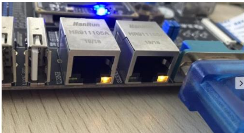
图 6.3.1-3 进入出厂系统后的网口灯
