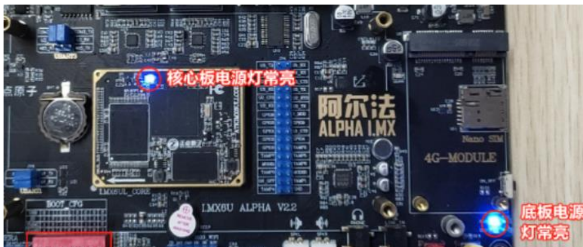
图 1.3.4-1 核心板电源灯
