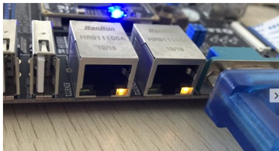
图 3.11.1-2 启动出厂系统后的网口灯
