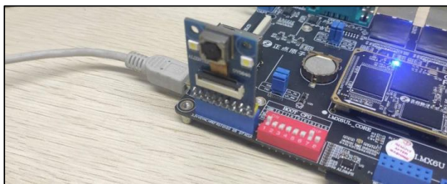
图 3.16.1 2 ov5640 与 ALPHA 开发板接法
