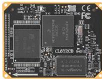
图 2.1-1 ATK-CL6Y2CB 核心板
