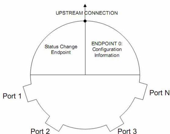
图中右上方是端点 0，即默认的控制端点，HOST 通过向该端点发送标准请求和 HUB 类请求完成 USB HUB 的枚举和控制。如复位某个下行 PORT、使能某个下行 PORT、给某个下行 PORT 上电等。
