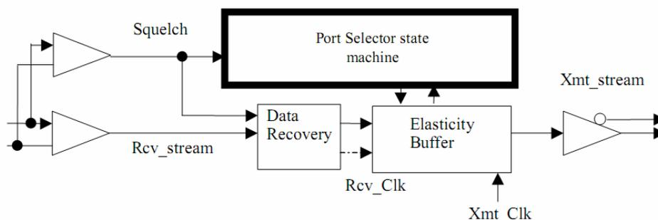
在我们的项目中，USB PHY 芯片完成了 HUB Repeater 大部分的电气层功能，如数据恢复、包检测等。在高速连接中，USB 规范要求从上行 PORT 到下行 PORT 的连接在 SOP (Start of Packet) 到来时建立，且延迟不超过 36bit time。实际实验过程中发现即使 USB HUB 的 Repeater 延迟超过 40bit time 也未导致功能失败。
