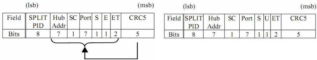
在 Start-Split 和 Complete-Split 包中主要指定了此次分离传输所在的 HUB 的地址和下行端口编号以及端点类型（控制、中断、批量、同步）。以及此次传输中数据包在整个数据中的位置（第一个包、中间的包、末尾的包）。
