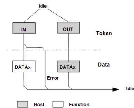
同步传输是不可靠的传输，所以它没有握手包，也不支持 PID 翻转。主机在排定事务传输时，同步传输有最高的优先级。
