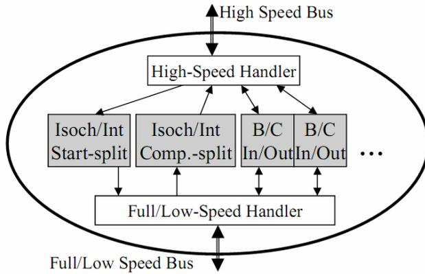
和大部分速度匹配逻辑一样，TT 也采用 Buffer 的方式来完成速度匹配。Buffer 的一端是一个高速 Handler，处理高速数据收发；另一端是全速/低速 Handler 处理全速/低速数据的收发。针对传输类型的不同，TT 采用多个 Buffer 来缓存数据。其中同步传输和
