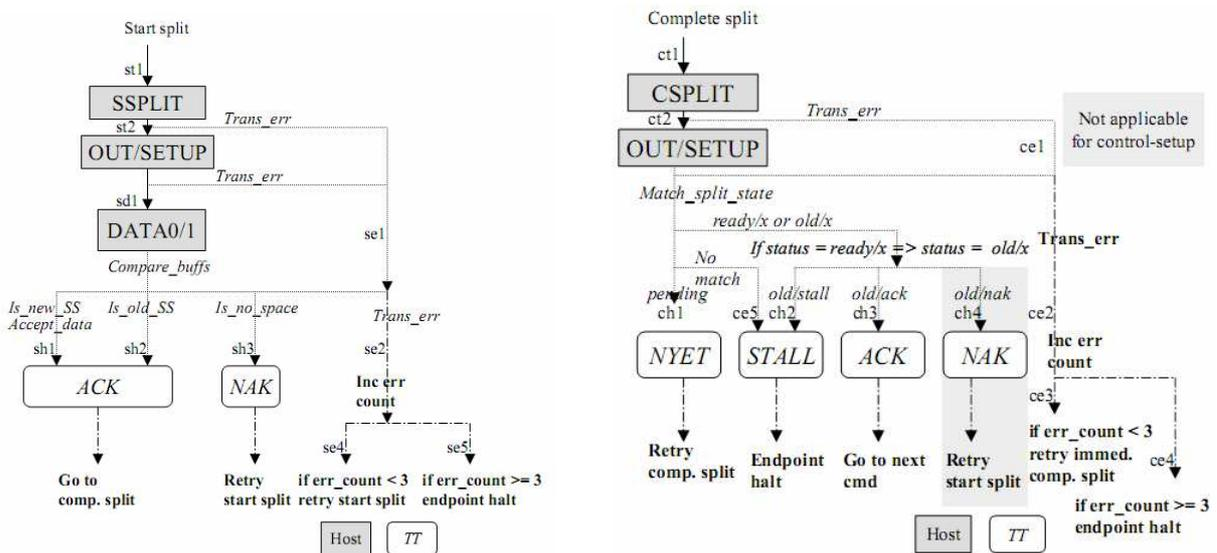
HOST 知道某个 HUB 的某个下行 PORT 上连接的是全速/低速设备（通过查询 HUB 的端口状态得知）。当 HOST 要向该设备传送数据时，它必须启动一次 OUT 型的分离传输。首先 HOST 发送一个 SSPLIT 包，表明：下面我要进行分离传输了。SSPLIT 包中指明了该分离传输所对应的 HUB 地址和 PORT 编号，同时也指明了端点的类型（具体定义参考 Start-Split 包的定义）。然后按照普通批量/中断传输的顺序，先发送一个 OUT/SETUP 的令牌包，然后发送一个数据包，并等待来自 HUB 的握手包。如果没问题，HUB 的 TT 会在 Buffer 开辟一片缓存保存以上接收到的三个包后，并 ACK 主机，表明已经接收到 Start-Split 阶段
