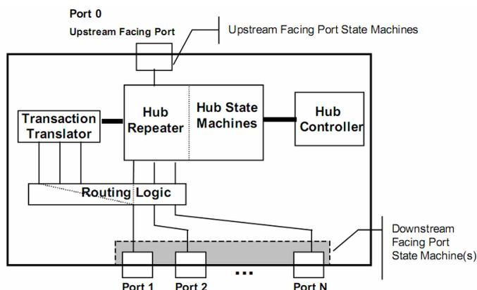
USB HUB 自身的工作速度由上行 PORT 的连接速度决定。从结构上分, USB HUB 由 HUB Repeater、HUB Controller 及 Transaction Translator 三部分组成。其中 HUB Repeater 主要负责连接的建立和撤销, 即完成上行 PORT 和下行 PORT 工作在相同速度的连接管理。同时还支持错误的检测与恢复以及设备连接/移除的检测。HUB Controller
