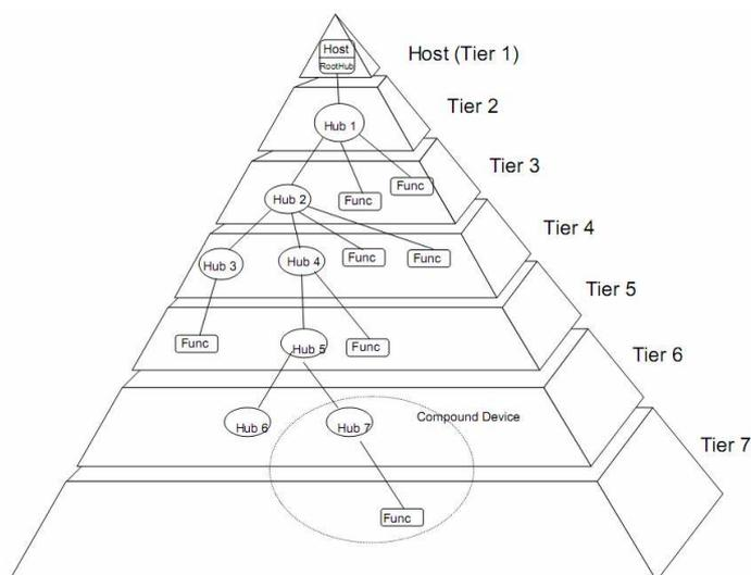
以 HOST-ROOT HUB 为起点，最多支持 7 层 (Tier)，也就是说任何一个 USB 系统中最多可以允许 5 个 USB HUB 级联。一个复合设备 (Compound Device) 将同时占据两层或更多的层。
