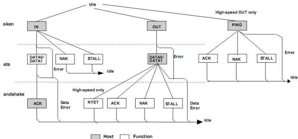
图中一个方框表示一个 Packet，灰色的包表示主机发出的包，白色的包表示 Device 发出的包。批量传输是可靠的传输，需要握手包来表明传输的结果。若数据量比较大，将采用多次批量事务传输来完成全部数据的传输，传输过程中数据包的 PID 按照 DATA0-DATA1-DATA0-...的方式翻转，以保证发送端和接收端的同步。
