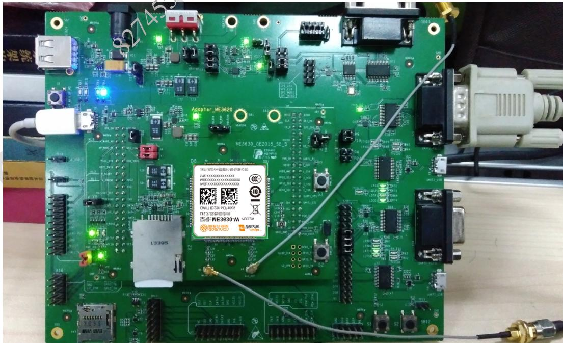
b. 使用外接电源，使用底板标准 USB，开发板最终状态如下图所示：
