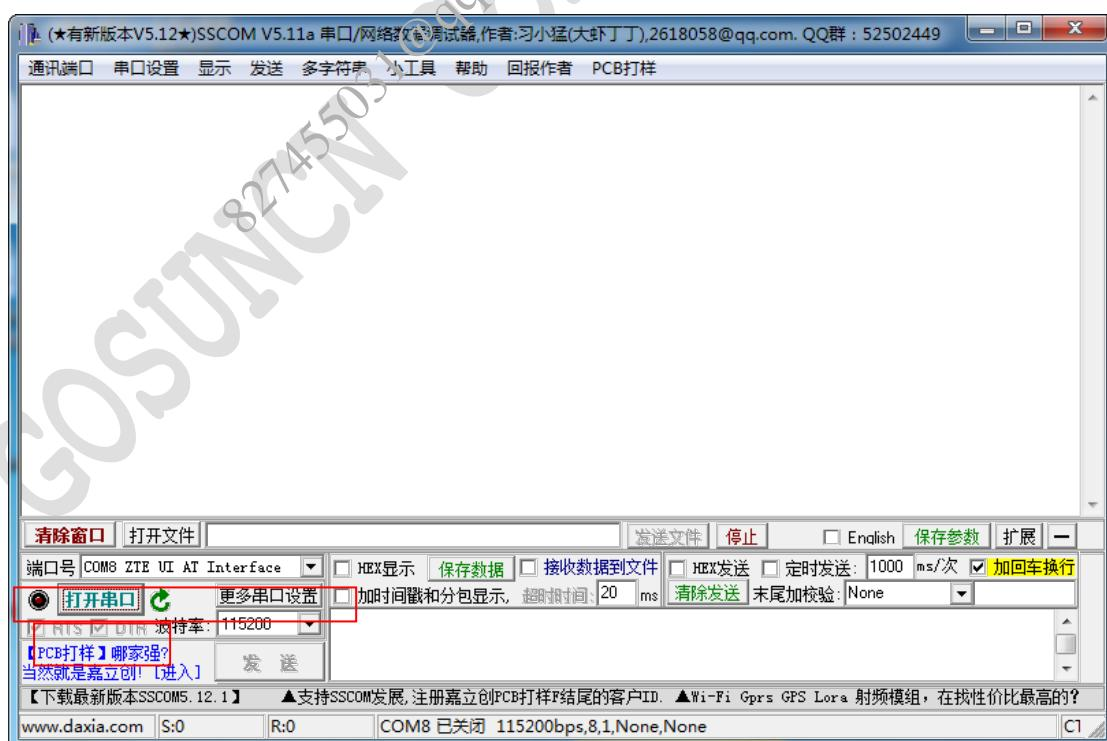
D . 在字符串输入框输入 AT , 点击发送 , 如果返回 OK , 证明 AT 收发正常。
