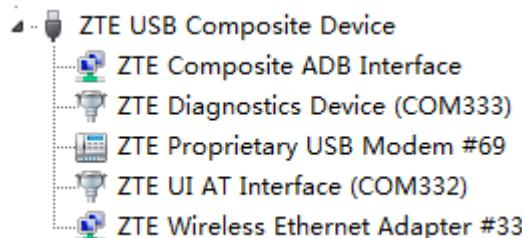
注意其中的 Diagnostics Device(COM333) , 下载会使用这个口。( 端口号会有变化 , 请注意使用 Diagnostics Device 设备即可 )
